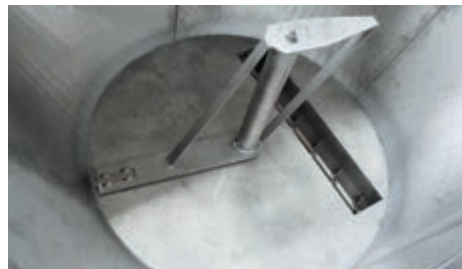
Дно емкости с Z-образной взмешивающей крестовиной и подающим шнеком
