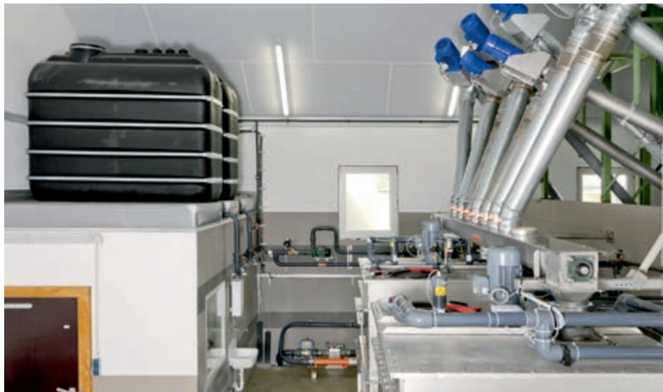
Кормокухня с системой на 2 бака с безостаточным кормлением и баком для чистой воды на 2000 л
