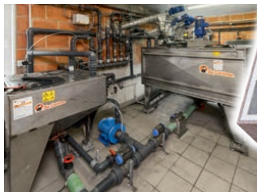
Кормокухня: система с 1 баком и взвешивающим БТВ
