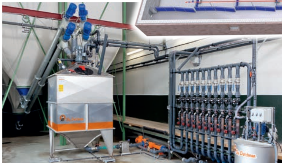
Кормокухня: система с 1 баком и заполненными тупиковыми кормолиниями для откормочника на 2000 голов
